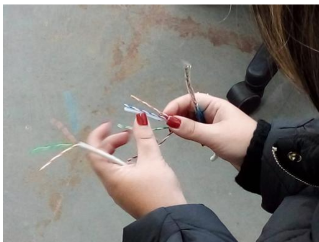
Figura 8. Discente separando os cabos para produzir um cabo de rede.
