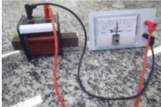
Figura 8 – Bobina e Galvanômetro
