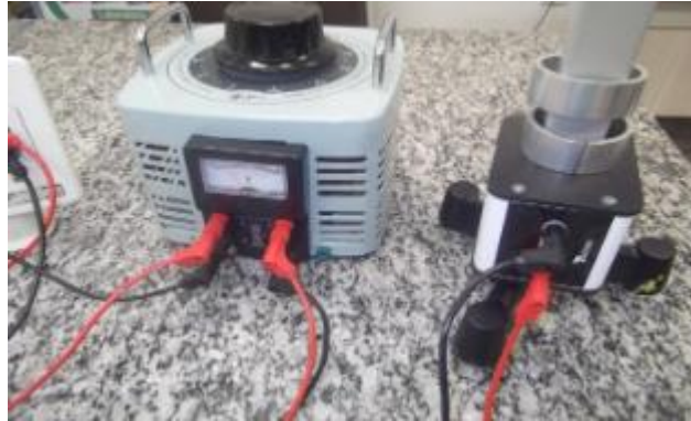
Figura 11 – Montagem do Anel de Thomson
