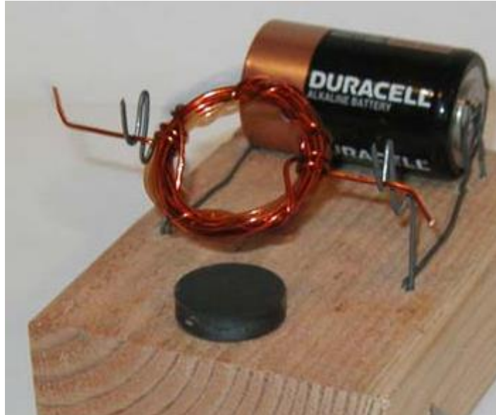
Figura 13 – Motor Elementar de Corrente Contínua
