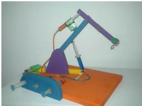
**Figura 7. Guindaste construído pelos alunos (modelo 1)<sup>8</sup>**
