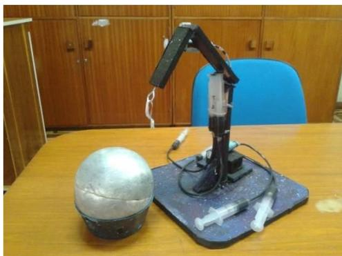
**Figura 8. Guindaste construído pelos alunos (modelo 2)<sup>9</sup>**
