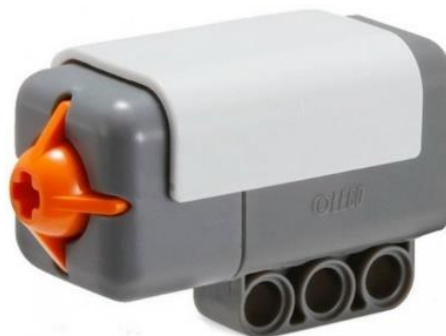
Figura 7 - Sensor de toque
