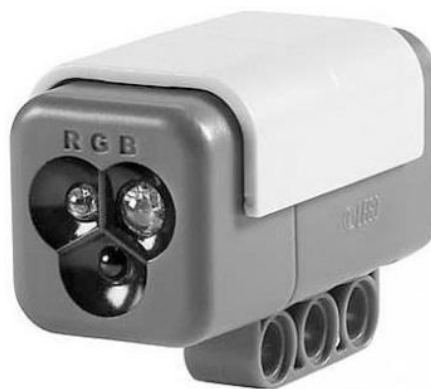
Figura 6 - Sensor de luminosidade
