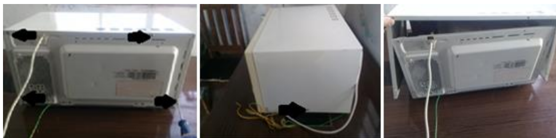
Figura 28: Retirada da proteção externa
