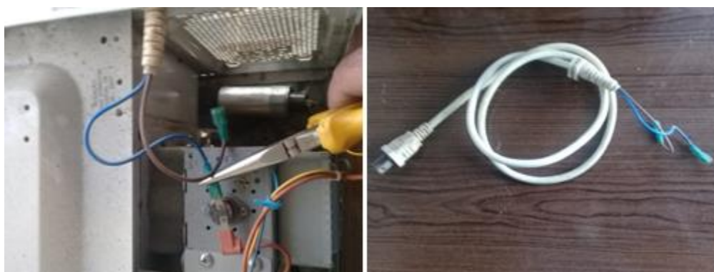
Figura 33: Retirada do cabo de alimentação
