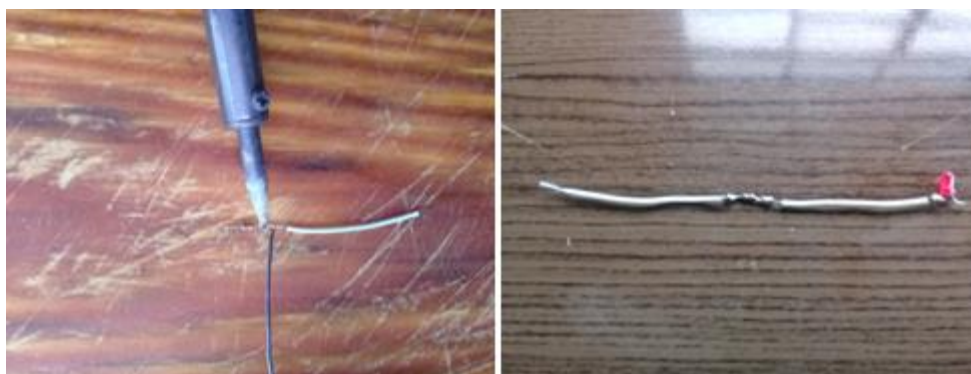
Figura 20: Solda do resistor e led
