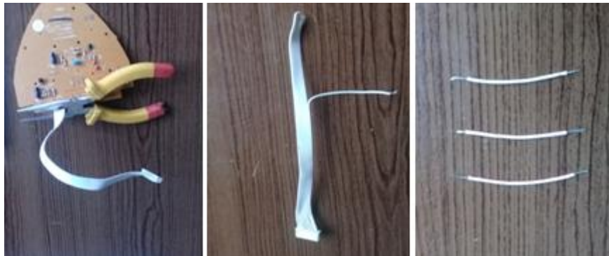
Figura 19: Preparação dos cabos para soldagem
