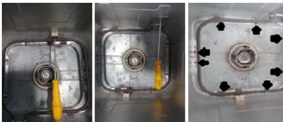
Figura 3: Retirada dos parafusos da caixa interna
