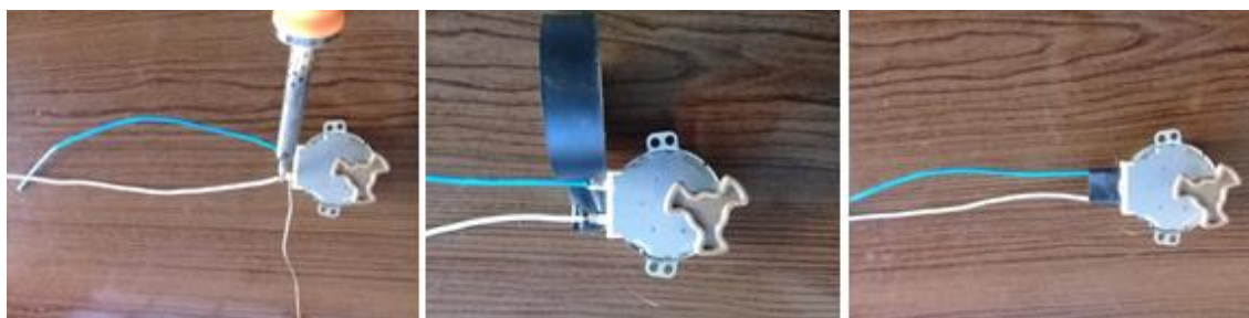
Figura 39: Soldagem dos cabos e isolamento dos terminais
