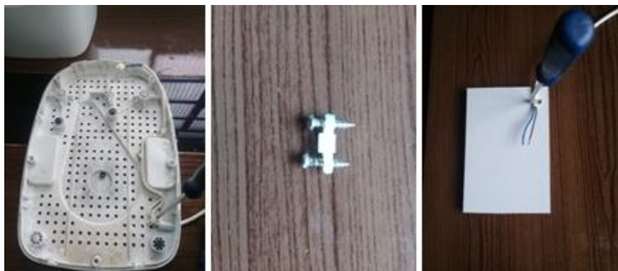
Figura 14: Fixação do cabo de alimentação
