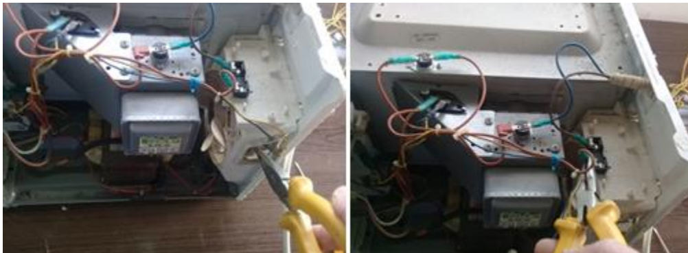
Figura 29: Retida dos cabos do ventilador e fusível
