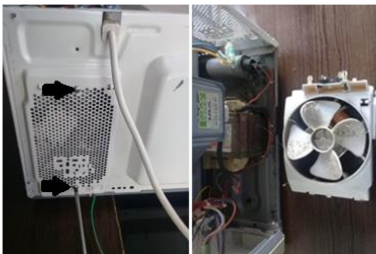
Figura 30: Retirada do transformador
