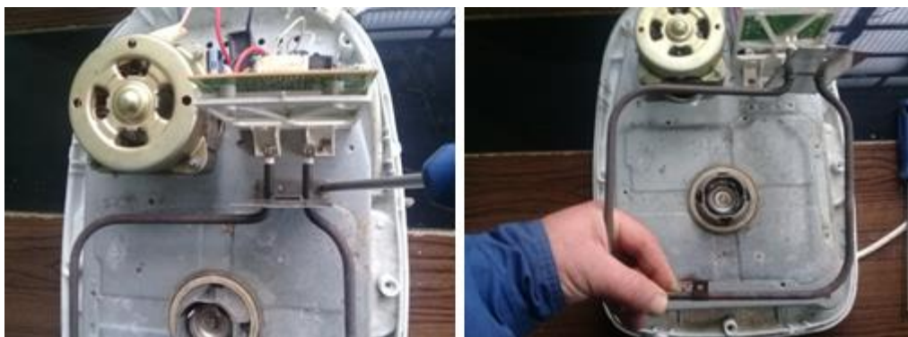
Figura 6: Retirada do resistor
