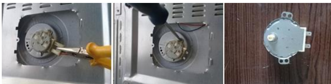
Figura 32: Retirada do motor do prato
