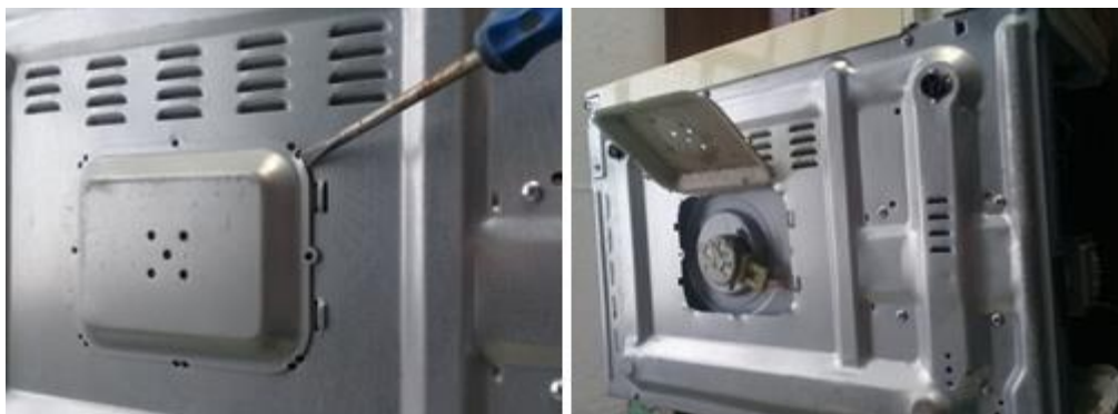
Figura 31: Retirada da tampa do motor do prato
