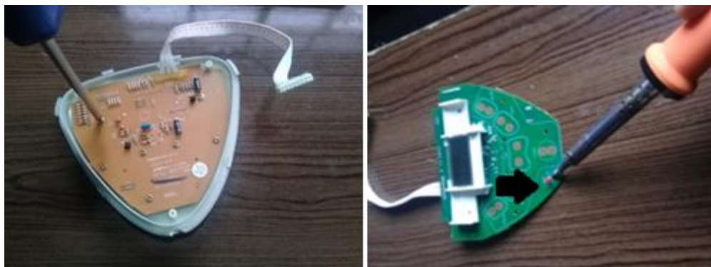
Figura 11: Retirada da placa da interface
