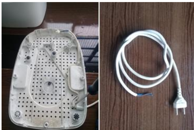
Figura 10: Retirada do cabo de alimentação
