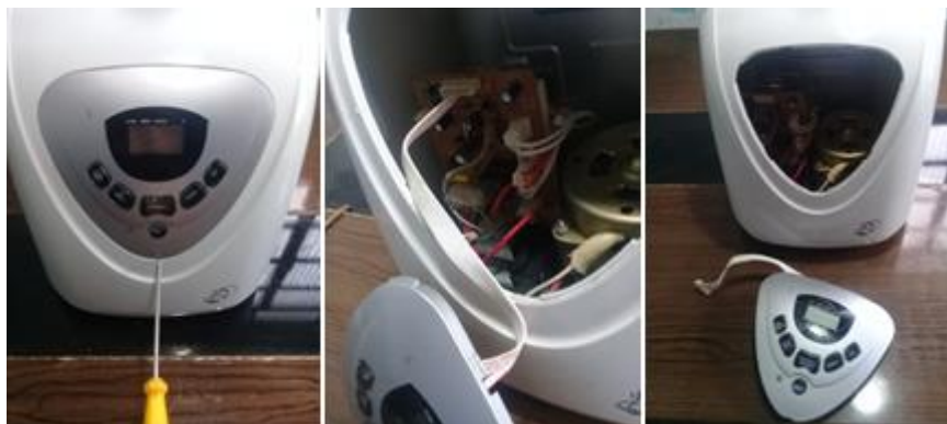
Figura 2: Retirada da interface
