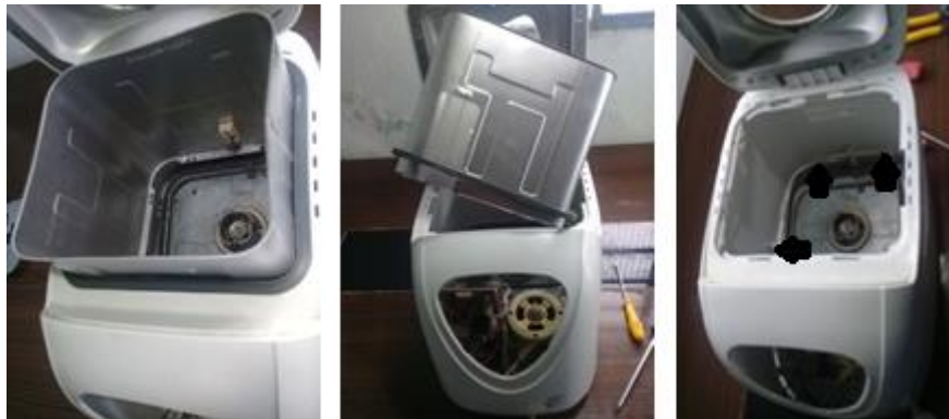
Figura 4: Retirada da caixa interna
