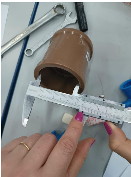
Figura 14 - Explicando as escalas do paquímetro
