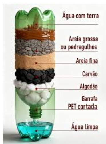
Figura 3. Exemplo de filtro caseiro
