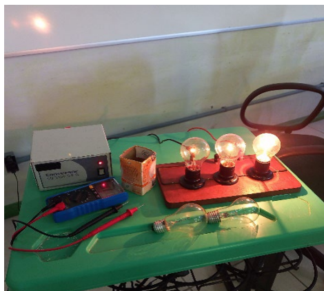
e) circuito com lâmpadas de potências diferentes
