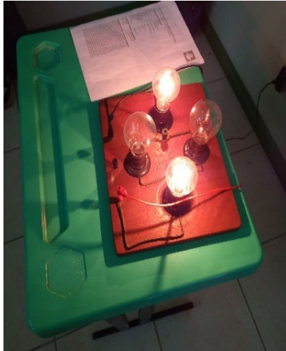
c) simulando comportamento circuito misto
